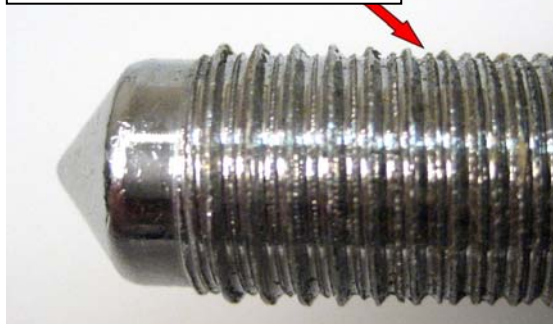
Filetage non conforme
