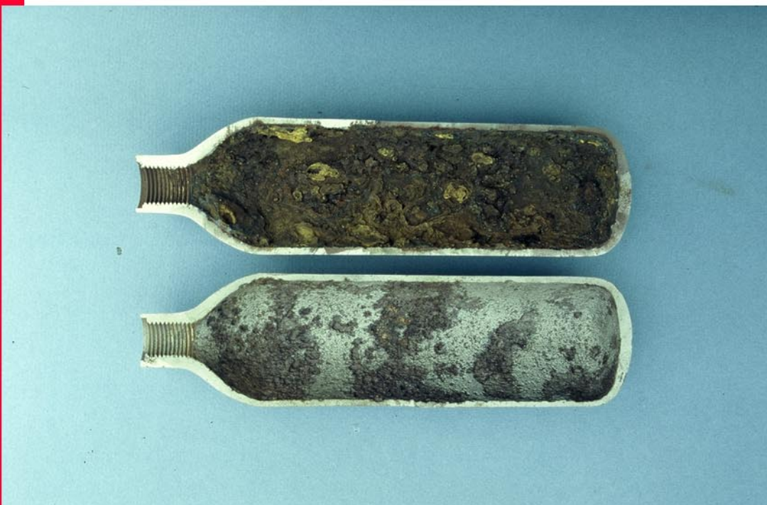
Corrosion généralisée dans une bouteille de gilet de stabilisation. avant et après grenailage
