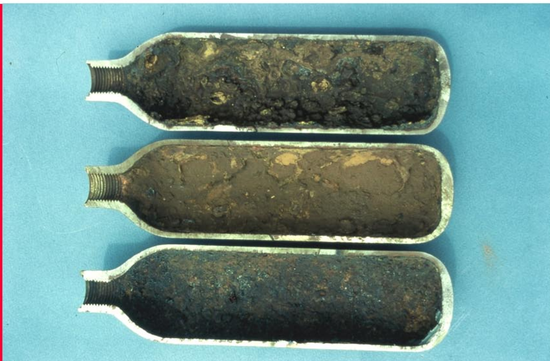
Corrosion généralisée dans des bouteilles de gilets de stabilisation. ayant contenu de l'eau de mer
